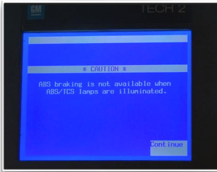
El sistema nos avisa que durante el procedimiento no estará disponible el sistema de frenos ABS cuando la luz testigo del sistema esté encendida.
