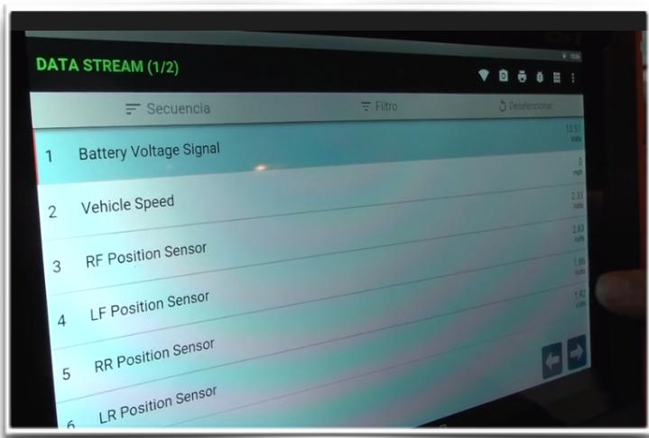
Entramos a la línea de datos del módulo de la suspensión y podemos visualizar los sensores de posición.
