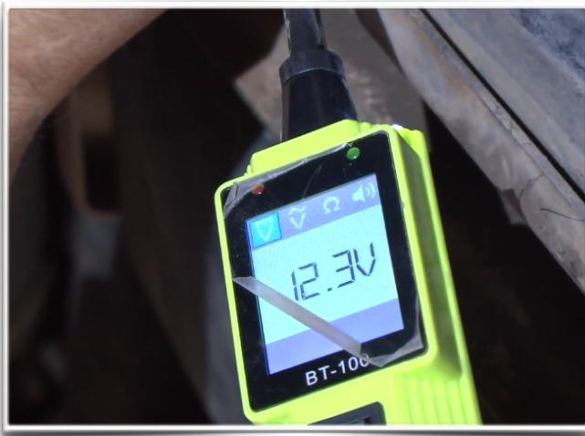
Y bien, tenemos masa, positivo y positivo de ignición, apreciamos que, al cortar el contacto, pasan unos segundos antes de que se pierda el voltaje de ignición que nos indica que la red se “duerme”
