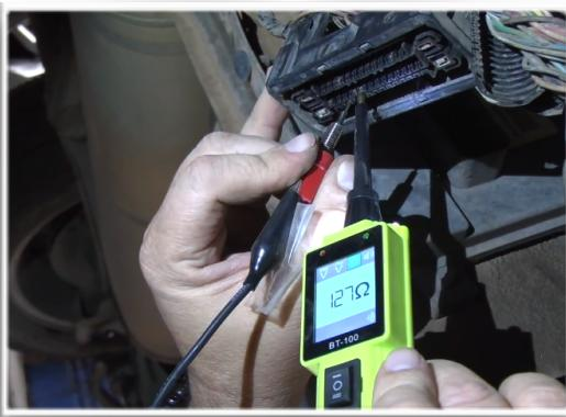
Aquí medimos la resistencia de la red, y vemos que tenemos los 120 Ohms en cada parte de las líneas de CAN Hi y de Can Low
