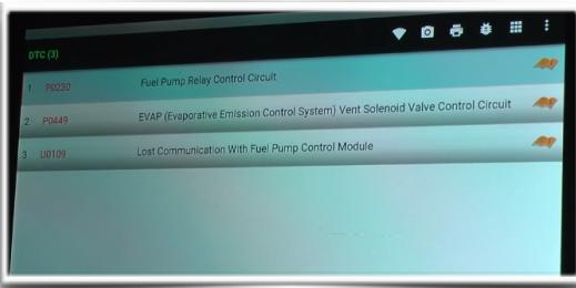
Entramos con el escáner al módulo de control del motor y vemos los códigos de falla y permanece el código de falla de la unidad de control de la bomba de gasolina, es decir, definitivamente el módulo está dañado.
