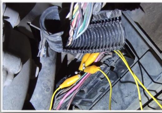
Hicimos un puente entre la entrada y la salida de CAN Hi y CAN Low respectivamente
