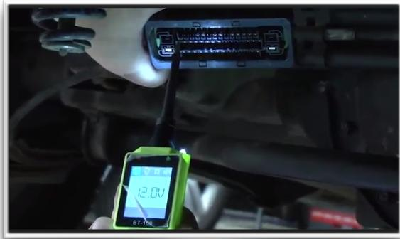
Ponemos el probador en el pin 31 y al poner el llavín de ignición en contacto, los 12 voltios llegan al Pin, definitivamente, el Body Control Module está despertando los módulos. ¡Ajá! Pero un momento, se escucha la bomba de combustible que suena sin parar, eso no es normal, pues la bomba es controlada por un módulo, al parecer tenemos la bomba conectada directa.
