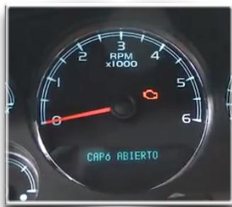
Fíjate que en el panel de instrumentos del vehículo nos aparecen advertencias, por ejemplo, nos avisa que el capó está abierto, esto es porque le hemos conectado el estabilizador de tensión en la batería para que durante la reprogramación no exista el peligro de una caída de tensión y arruine los módulos.
