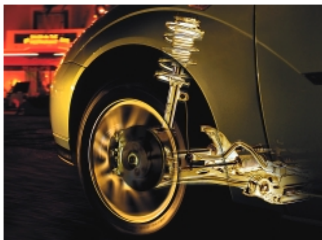
Suspensión McPherson. Ford Focus
