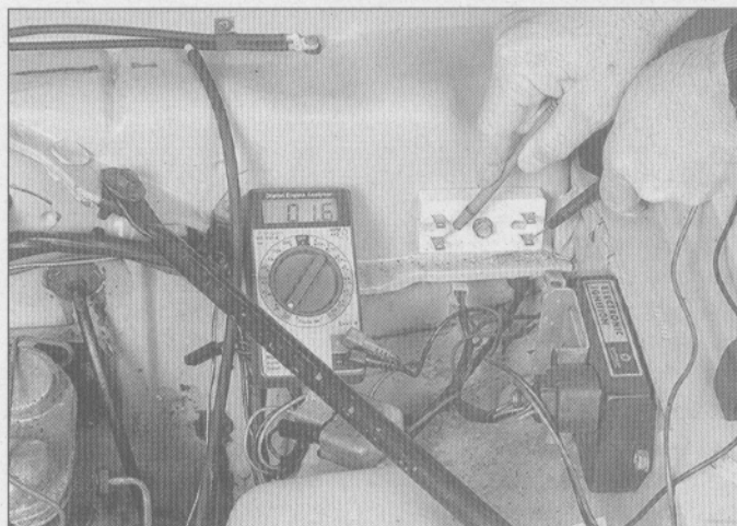
4.82 Chequee el lado primario de un resistor de bobina de tipo doble en un típico sistema de encendido Chrysler
