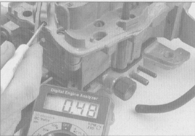
2.34 ... luego use un destornillador pequeño para girar el tornillo de ajuste hasta que las lecturas sean correctas
