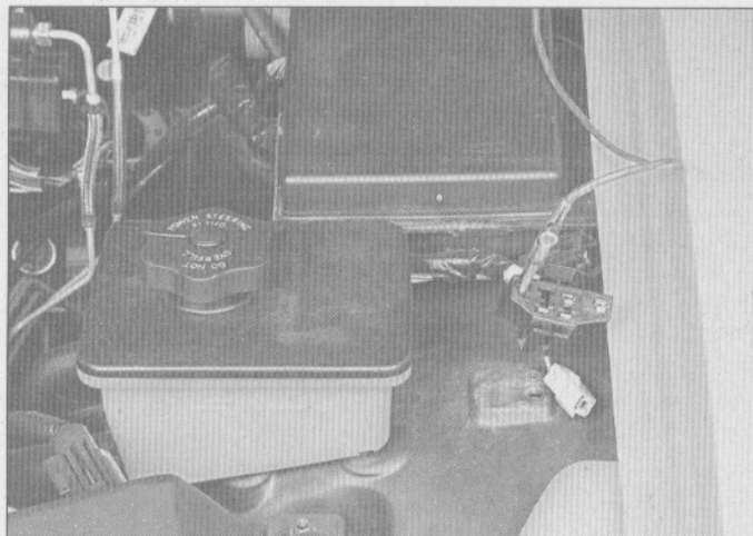
1.21 En los sistemas Ford, conecte a tierra el terminal FP terminal (terminal en la parte superior izquierda) para activar la bomba de combustible
