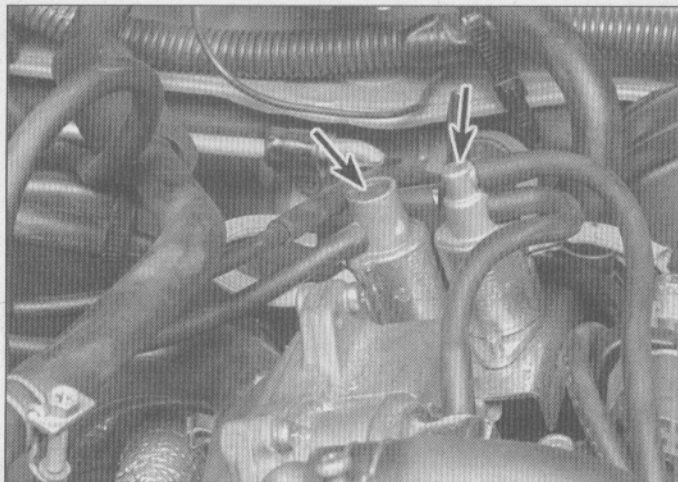
2.1 Algunos solenoides EGR (de control de recirculación de los gases de escape) están montados sobre pequeños soportes que pueden instalarse en cualquier parte del compartimiento del motor - el solenoide de control de EGR, o el solenoide de interrupción de vacío se encuentra a la izquierda en este Nissan Maxima (el solenoide de control de la derecha es para la válvula de inyección de aire)
