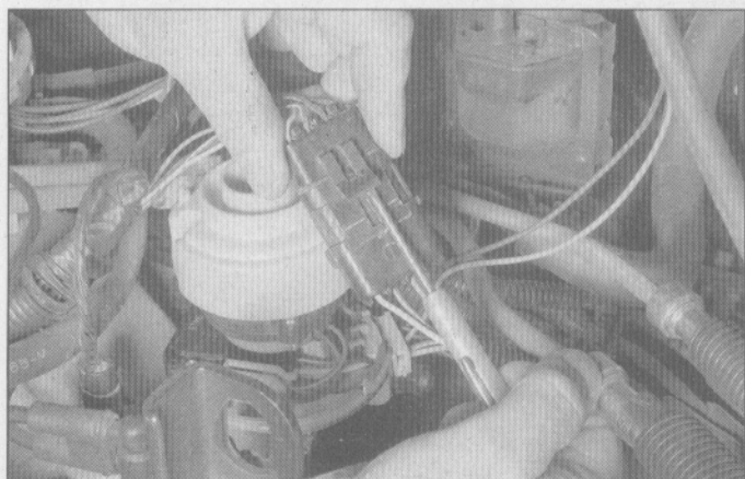
4.69 Use un pequeño destornillador para abrir la orejeta de trabado en el conector del distribuidor (sistema HEI (sistema de ignición de alta energía) de GM)
