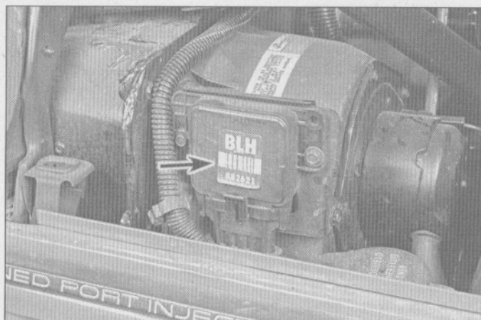
3.22 En muchos modelos GM, la información del sensor de detonación se envía al módulo (flecha) de control electrónico de la chispa (ESC), el cual retrasa la sincronización del encendido si hay evidencia de detonación
