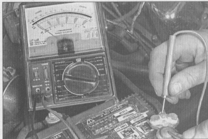
8.2 Aquí se está chequeando la conexión del cable de una batería para descubrir una caída de voltaje que podría ser causada por corrosión o una conexión floja.
