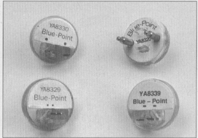
5.15 Una luz "noid" proporciona una manera rápida y fácil de chequear la señal eléctrica al inyector del combustible
