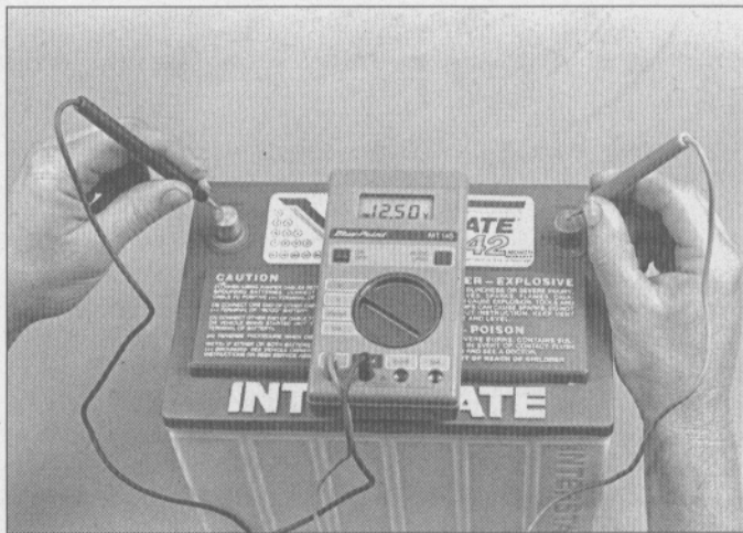
5.12 Mida el voltaje de la batería usando el voltímetro, con un electrodo en cada receptor de la batería. Coloque el electrodo positivo al receptor positivo y el electrodo negativo al receptor negativo.
