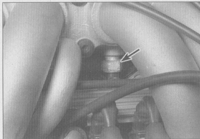
9.5 He aquí un sensor MAT (Sensor de temperatura del aire del múltiple de admisión) típico (éste pertenece a un Corvette de 1985) - está ubicado en la parte inferior del plenum de admisión de aire
