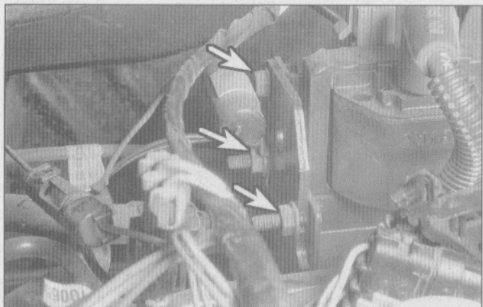
4.42 Ubicaciones de los pernos de montaje (flechas) de la bobina en un motor GM V6 de 3.1L
