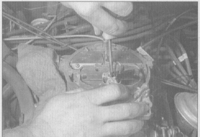
2.29 La herramienta calibradora especial aquí mostrada es necesaria para chequear el ajuste de la válvula de sangrado de aire. Use un destornillador grande, como el que se muestra aquí, para ajustar la válvula
