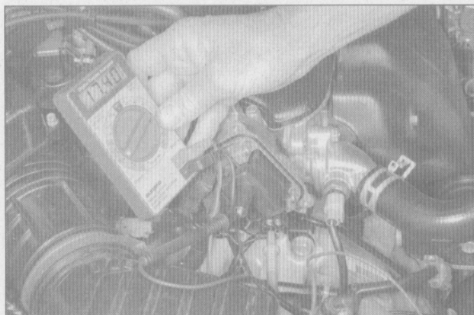
4.37 Chequeo de la resistencia del devanado secundario de la bobina integral de un vehículo Honda
