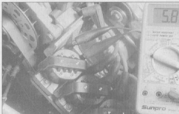
4.48 Seguidamente, mida la resistencia secundaria a través de ambas torres de cada bobina (se muestra aquí un motor GM V6 de 3.1L)
