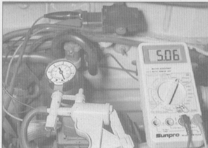
3.3 El voltaje del sensor MAP (sensor de la presión absoluta del múltiple de admisión) (medido en el cable de señales) disminuirá cuando se aplica vacío al sensor
