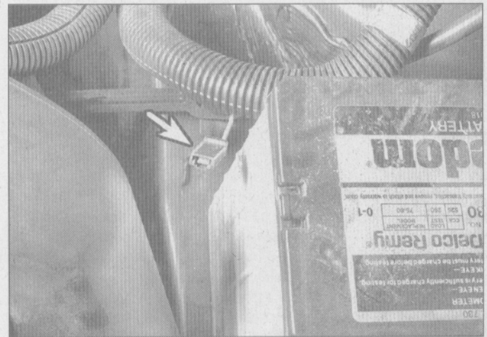
1.20 El terminal de prueba de la bomba de combustible en muchos vehículos GM se encuentra al lado de la batería
