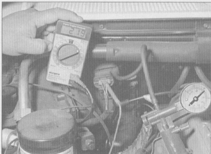
3.5 Aplique ahora vacío (20 pulgadas de Hg) y el tacómetro debe leer entre 200 y 230 rpm (revoluciones por minuto)
