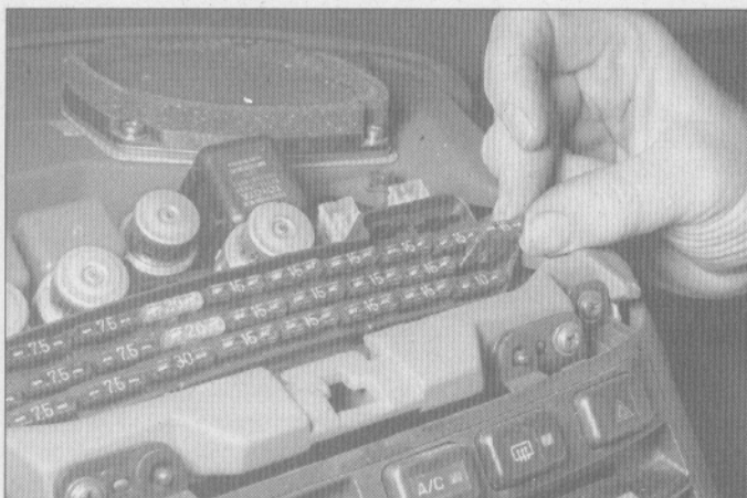
1.4 Ubicación del fusible de la bomba de combustible en los minifurgones Toyota Previa
