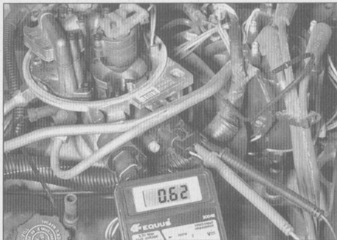
3.12 En un TPS (sensor del ángulo de apertura del acelerador) típico, la gama de voltaje debe ser de 0.4 a 5.0 voltios. Inserte la punta de prueba positiva del voltímetro en el cable de señales y la punta de prueba negativa en el cable de tierra y abra lentamente el acelerador hasta su abertura máxima
