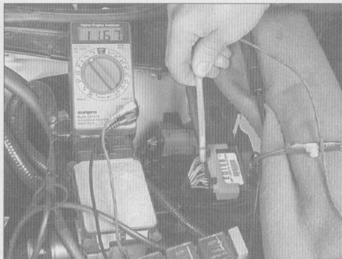
4.74 En los sistemas EDIS de Ford, inserte la punta de prueba en el terminal número 6 para chequear si hay voltaje de la batería proveniente del relé de alimentación eléctrica
