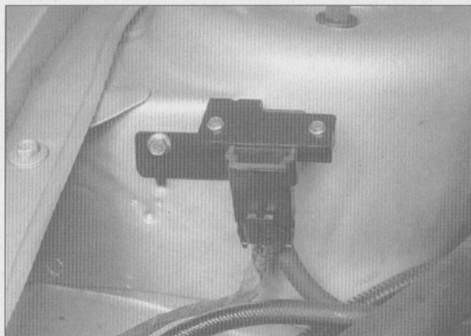
2.7 Sensor MAP (sensor de la presión absoluta del múltiple de admisión) típico - algunas veces estos sensores van montados en el tabique o pared para cortafuegos, como éste, o a un lado de la caja del purificador de aire
