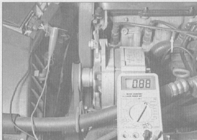
3.7 El voltaje de la señal en un sensor típico MAF (sensor del flujo de la masa del aire) de Bosch será de 0.60 a 0.80 voltios en marcha mínima y ...
