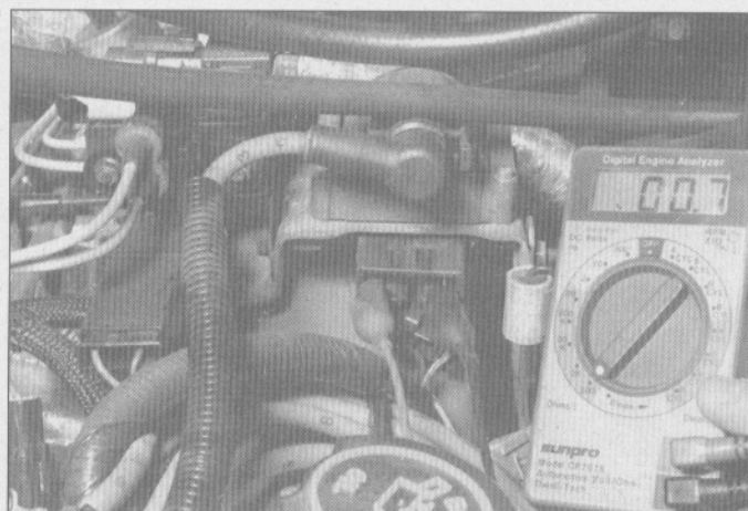
4.31 Chequeo de la resistencia del devanado primario de la bobina en un sistema TFI-IV (película gruesa integrada) Ford
