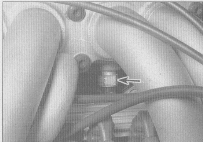
3.11 He aquí un sensor MAT (Sensor de temperatura del aire del múltiple de admisión) típico (éste es de un Corvette de 1985) - está ubicado en la parte inferior del plenum de admisión de aire
