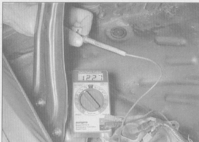
1.22 Chequee si hay voltaje de la batería en la bomba de combustible usando un voltímetro. En algunos vehículos, será necesario remover la alfombra para obtener acceso al conector eléctrico de la bomba de combustible (se muestra aquí un Honda Accord reciente).
