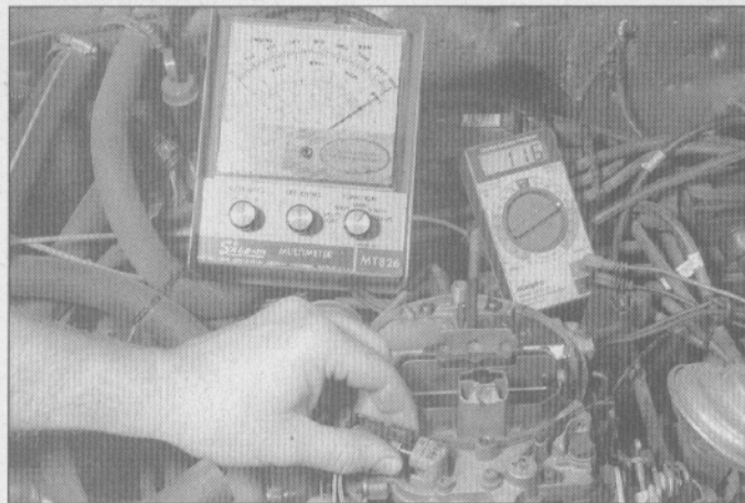
2.23 Estando el DWELL (medidor del ángulo) y el tacómetro apropiadamente instalados, desconecte el conector del solenoide M/C (mezcla del combustible) y observe el tacómetro. Deben descender 300 rpm del nivel normal.
