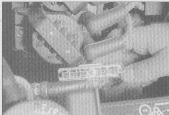
4.75 En los minifurgones APV (vehículo para todos los propósitos) de GM, afloje el perno de retención del conector eléctrico y remueva el conjunto del módulo de encendido. Siga el color de los cables de un diagrama o esquema del cableado eléctrico del sistema DIS (sistema de ignición sin distribuidor)
