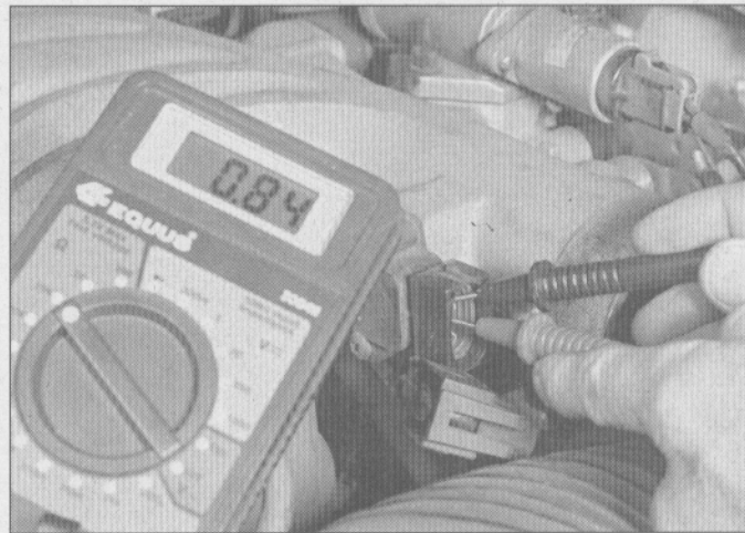
3.13 Mueva lentamente el acelerador y observe las lecturas de resistencia en la pantalla del voltímetro digital - debe haber una transición uniforme a medida que aumenta la resistencia
