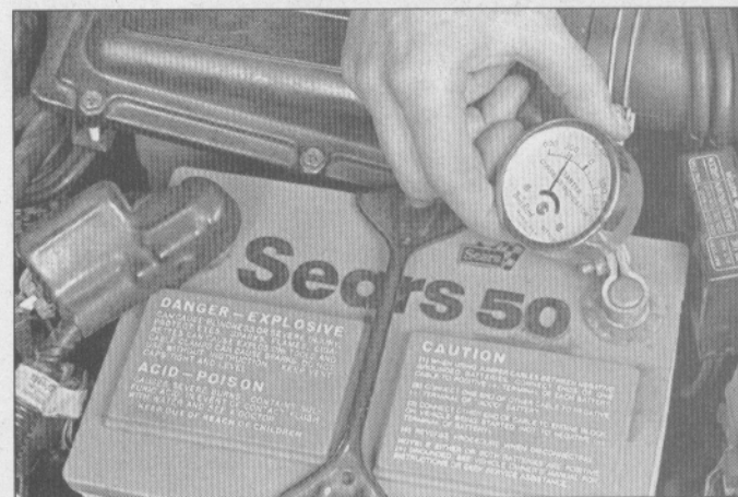
8.4 Este es otro amperímetro inductivo sencillo que se usa para chequear el arrastre del motor de arranque mientras se gira el motor.
