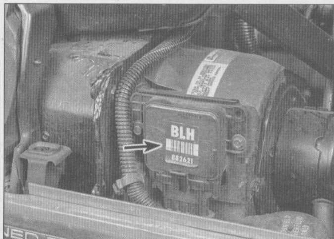
9.13 En muchos modelos GM, la información del sensor de detonación se envía al módulo ESC (flecha) de control electrónico de la chispa, el cual retarda la sincronización del encendido si hay evidencia de detonación
