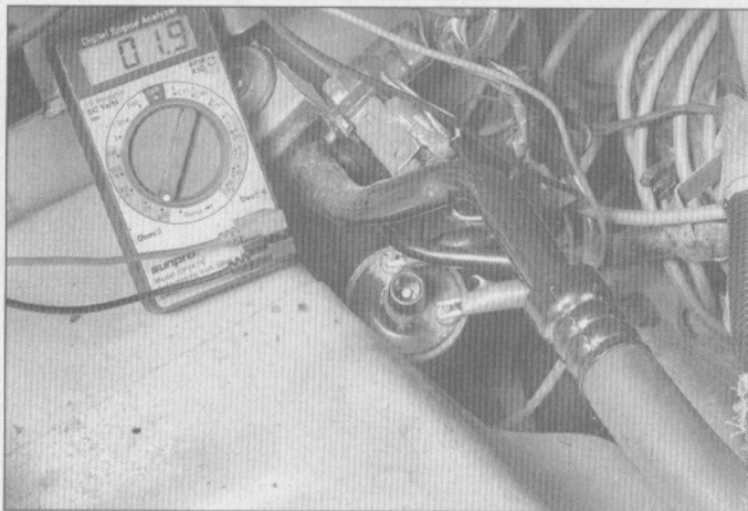
4.30 Chequeo de la resistencia del devanado primario de la bobina en un vehículo Chrysler típico
