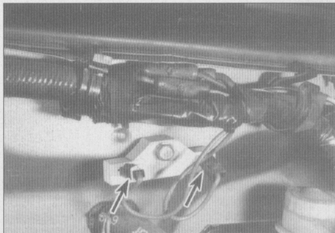
4.80 Para chequear el resistor de la bobina, desconecte los cables y toque los terminales del resistor con las puntas de prueba del ohmímetro
