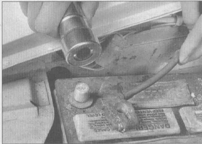
5.8 Sin importar el tipo de herramienta que se use en los receptores de la batería, el resultado siempre debería ser el de una superficie limpia y brillante.
