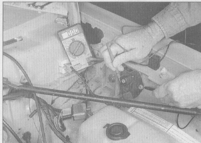
4.54 Chequee si hay continuidad eléctrica en el circuito de conexión a tierra (patilla número 5) y la tierra del módulo de encendido (Chrysler)
