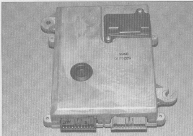
3.1 Removida del vehículo, la computadora no parece gran cosa, pero es el cerebro que controla el motor y a menudo mucho más
