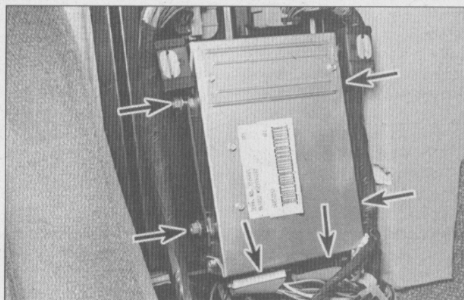
12.3 Una tercera ubicación de la computadora está entre los asientos, como en este Pontiac Fiero, o incluso debajo de uno de los asientos anteriores (las flechas señalan el conector eléctrico y los pernos de montaje).
