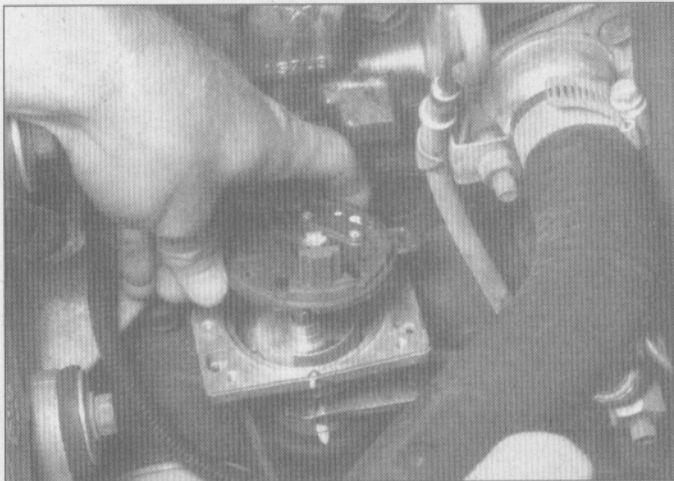
4.19 Remueva el conjunto colector de efecto Hall levantándolo del eje del distribuidor (se muestra aquí un motor de cuatro cilindros)
