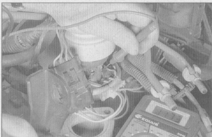
4.70 Chequee si hay voltaje de la batería en el terminal + (cable rosado) en el módulo de encendido (sistema HEI (sistema de ignición de alta energía) de GM)
