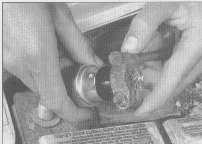
5.9 Cuando limpie las abrazaderas de cable, toda la corrosión se debe remover (el interior de la abrazadera tiene forma cónica que corresponde a la forma del receptor, así que no remueva demasiado material).
