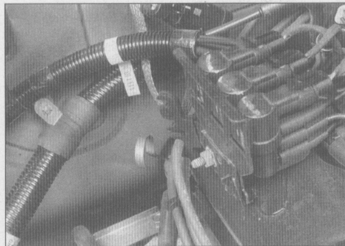
1.20 Busque los solenoides de control reunidos en un grupo, tal como éste en un Dodge Dakota - este solenoide conmutador controlado por computadora controla la señal de vacío hacia el interruptor/válvula de alivio en el sistema de inyección de aire
